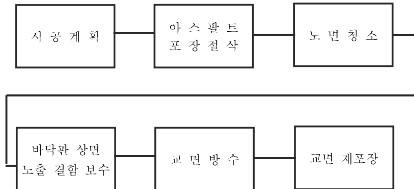
【그림 7-5】 상면 교면방수 및 재포장 순서
